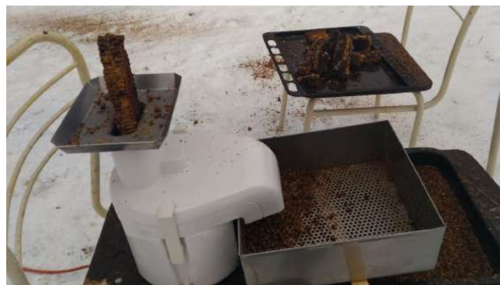
Obr. 1 Mlynček na spracovanie pergy a nerezové sito na separáciu peletiek pergy od vosku. (foto: Staroň, 2018)
