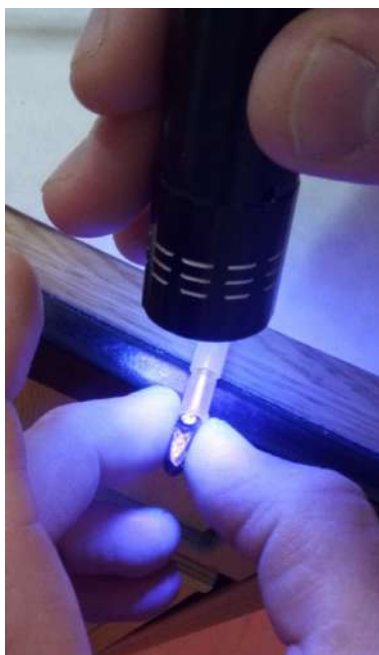
Obr. 3. Tienenie hlavy matky v olivke injekčnej ihly počas expozície gélu (lepidla) UV svetlom. (foto: autor)
