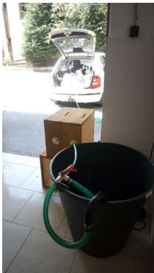
Obr. 3. Napĺňanie sirupu do transportných nádob za pomoci čerpadla a tankovacej koncovky s digitálnym prietokomerom. (foto: M. Staroň)
