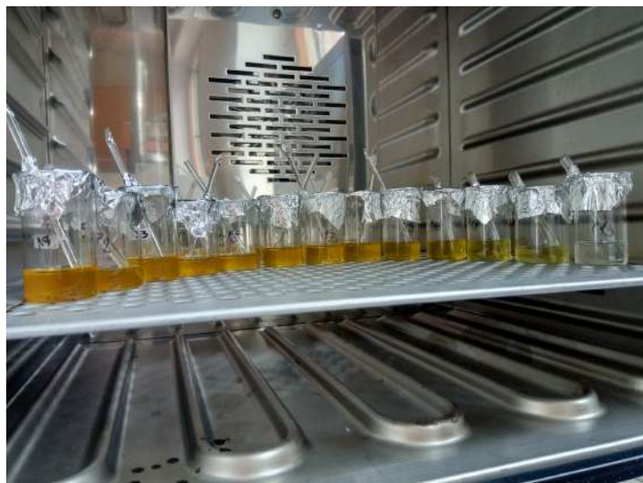
Obr. 2. Sada kalibračných vzoriek pre vosk s parafínom - rozpúšťanie. (foto: V. Kňazovická, 2019)
