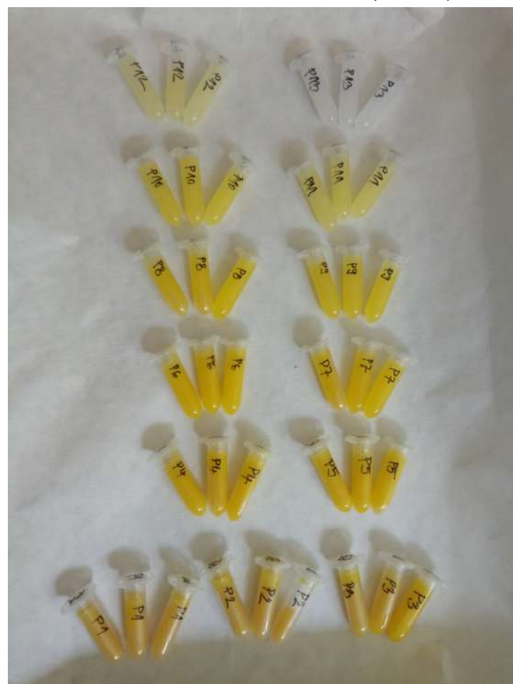
Obr. 3. Sada kalibračných vzoriek pre vosk s parafínom - hotové vzorky na kalibráciu. (foto: V. Kňazovická, 2019)
