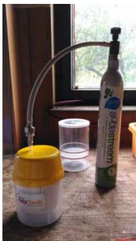
Obr.1: Zostava na diagnostiku za pomocí CO<sub>2</sub>. V pozadí iný typ komerčne predávanej diagnostickej nádobky.
